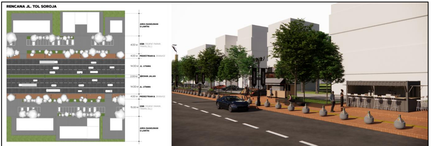
Gambar 8. Geometri Penampang Penataan Segmen 2 pada Koridor Jalan Tol Soreang-Pasirkoja Axis Menuju Pusat Pemerintahan Ibu Kota Kabupaten Bandung Sumber Gambar: Bapperida Kabupaten Bandung, 2024
