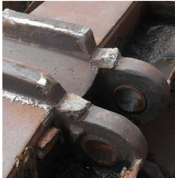
Gambar 3. Daerah Pertemuan Link Track – Sproket yang Cepat Aus dan Rusak Sumber: penulis
