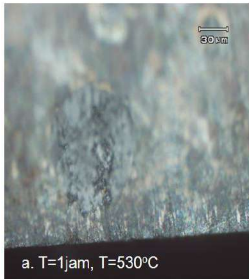
Gambar 10. Gambar struktur mikro yang telah dinitridasi dengan derajat ketersediaan urea 0,25 g/mm 2 , t = 1 jam, dengan T = 530 °C dan T = 550 °C,
