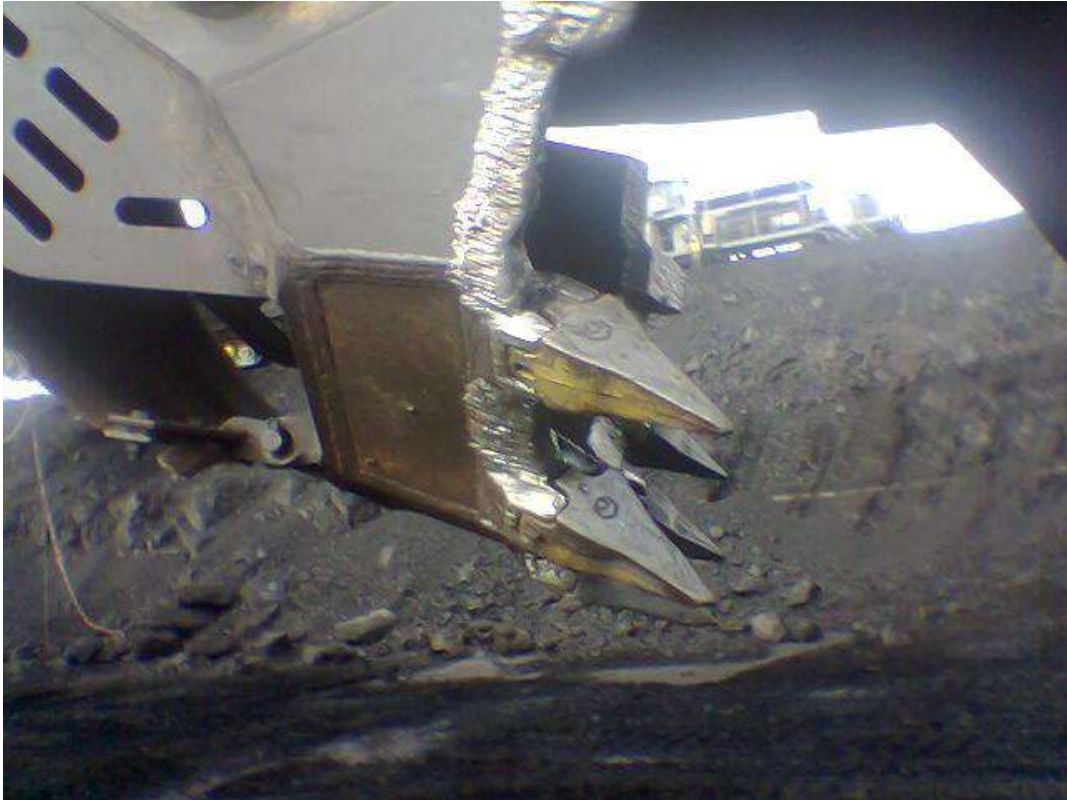
Gambar 2. Bucket Teeth Produk Polman pada BWE di PT Bukit Asam Sumber: penulis
