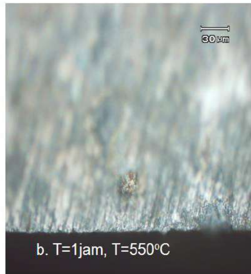
Gambar 10. Gambar struktur mikro yang telah dinitridasi dengan derajat ketersediaan urea 0,25 g/mm 2 , t = 1 jam, dengan T = 530 °C dan T = 550 °C,
