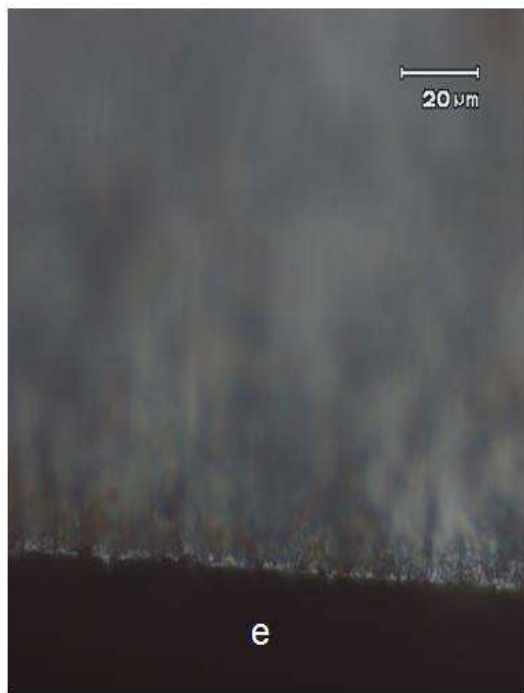
Gambar 12. Gambar struktur mikro yang telah dinitridasi dengan derajat ketersediaan urea 0,25 g/mm 2 . (e) t = 1 jam, T = 620 °C, lapisan senyawa nitrida = 1,38 μm. (f) t = 2 jam, T = 530 °C, Lapisan senyawa nitrida
